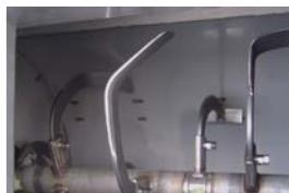
ステンレス製のブレード(刃)が回転し、生ゴミを破碎。回転軸に対するブレードの取り付け角度がそれぞれに異なることで、生ゴミのより細かな破碎と搅拌を実現しました。[特許第3041620号]
